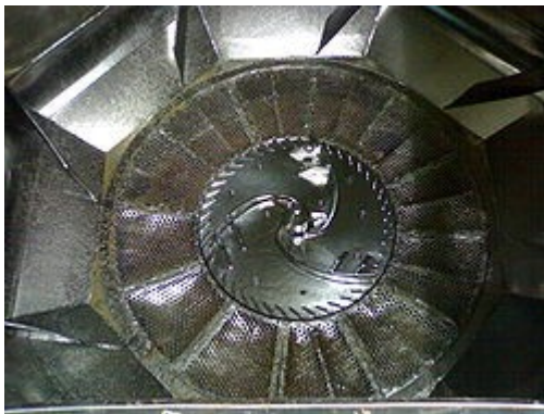
Vista de la hélice de un pulper
