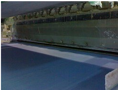
Vista de los labios de la cabeza de máquina.
